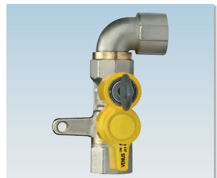
art. 1036G F/F with aluminium T-handle with turnable lockable fitting with key, 3/4" x 3/4" - 1" x 1" F/F mit Alu-Flügelgriff und drehbarer, verschließbarer Verschraubung komplett mit Schlüssel 3/4" x 3/4" - 1" x 1"
