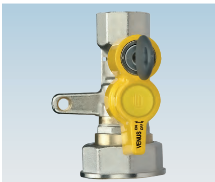
art. 1034G F/F with aluminium T-handle with straight lockable fitting with key 1"1/4 x 3/4" - 1"1/4 x 1" and 1/4" connection F/F mit Alu-Flügelgriff und gerader, verschließbarer Verschraubung komplett mit Schlüssel, 1"1/4 x 3/4" - 1"1/4 x 1" mit 1/4"-Anschluss"
