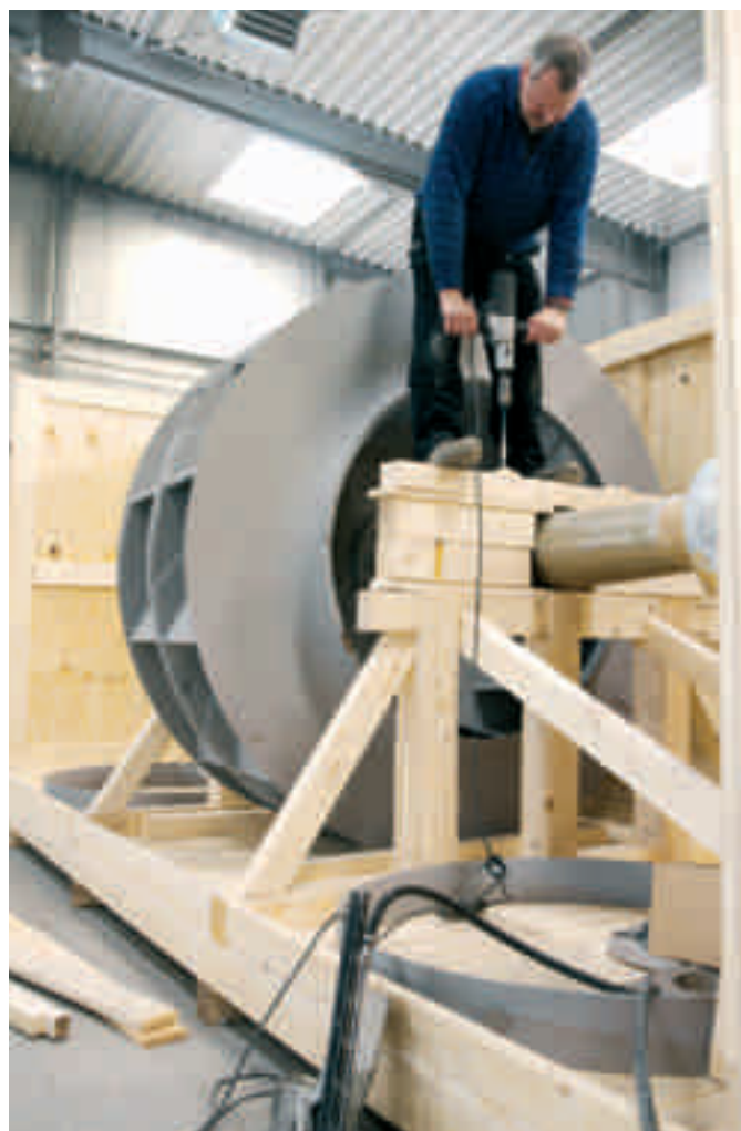
Упаковка отремон- тированного двухпо- точного ротора на деревянном трансп- ортировочном каркасе для надеж- ной перевозки
