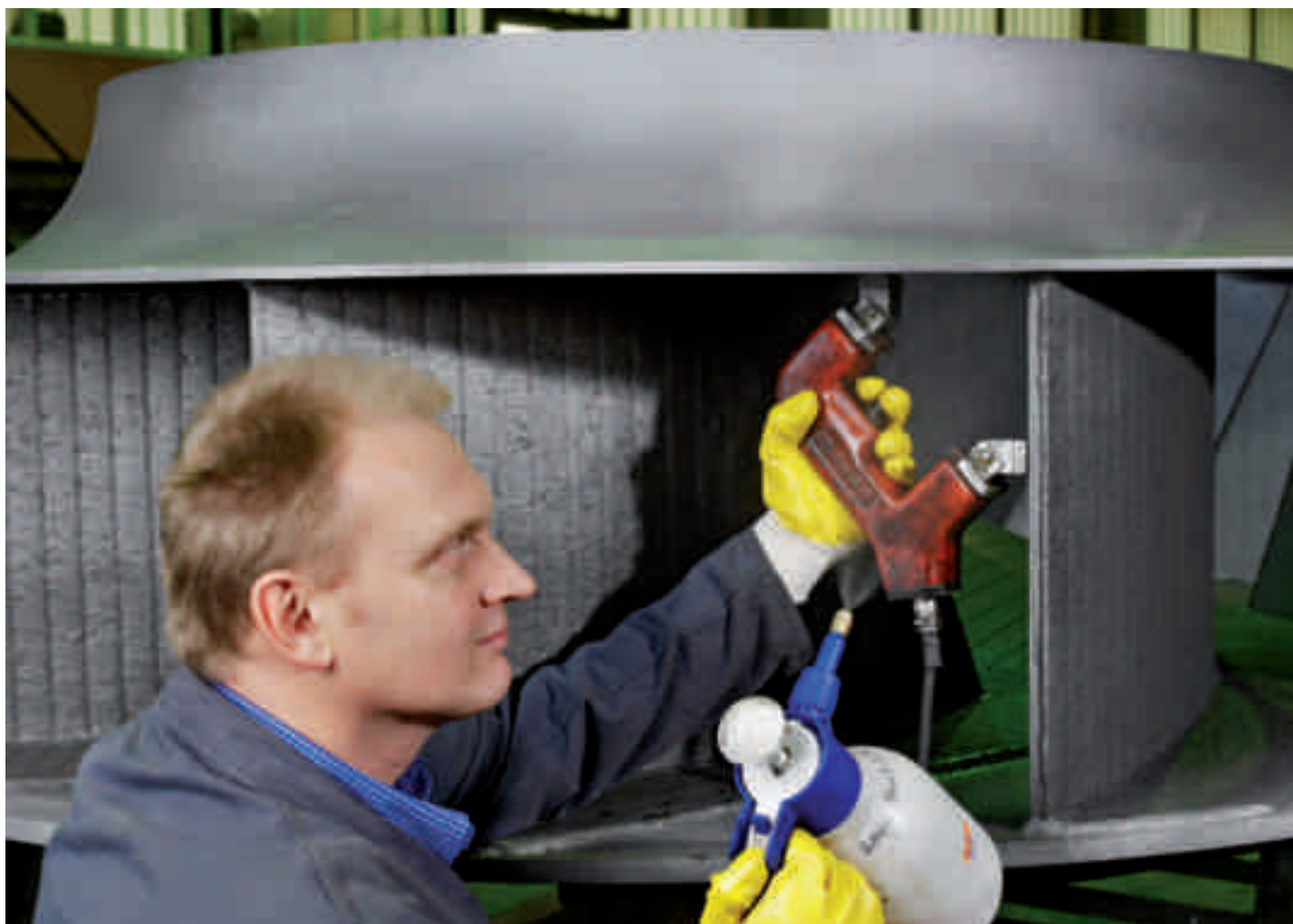
Поверхностная дефектоскопия (МР) сварных швов после выполненно- го ремонта
