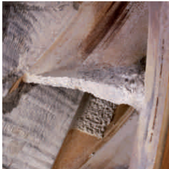
Крыльчатка, используемая в цементной промышленности, с наслоениями и сильным износом в области входа лопастей, а также на заднем диске
