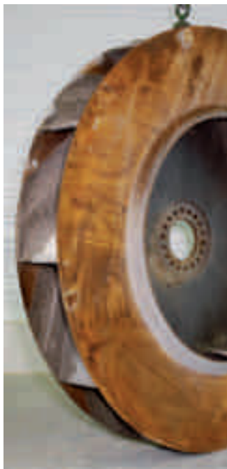
Крыльчатка, используемая в цементной промышленности, с наслоениями и сильным износом в области входа лопастей, а также на заднем диске
