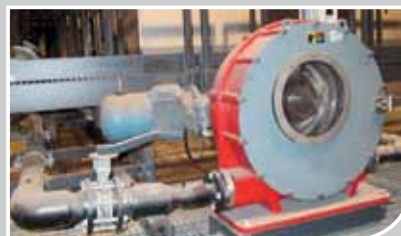
Циркуляционные насосы для промывной жидкости, эксплуатируемые на руднике Talvivaara.
