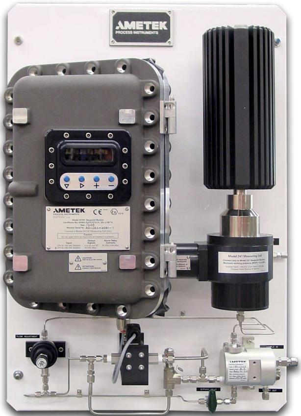
На встроенный дисплей кроме значения точки росы по углеводородам выводится информация о последнем значении измеренной температуры точки росы, рабочем давлении внутри измерительной ячейки (при наличии датчика), продолжительности работы монитора, диагностика состояния работы монитора и другая служебная информация. Имеются токовые выходы 4-20 мА для непрерывной регистрации измеренной точки росы и условного кода состояния.
