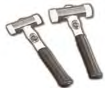
Нежесткий молоток (чтобы обеспечить хорошую посадку муфты на трубе большого диаметра).
