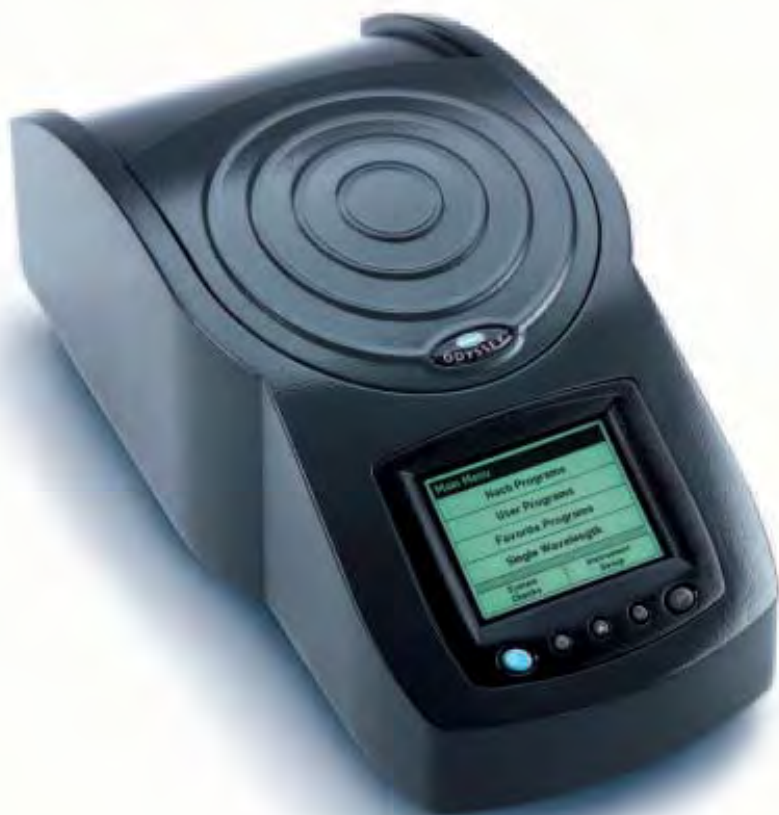
DR/2500—спектрофотометр, специально предназначенный для анализа питьевых и технологических вод в лабораторных условиях
