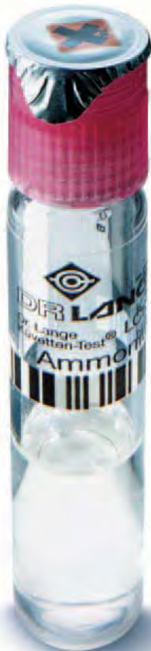
Многоцелевая кювета — контейнер для транспортировки, дозировки, разложения пробы, проведения реакции, измерения и последующей утилизации
