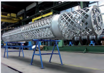
Ротор с центробежными чистящими элементами из тефлона
