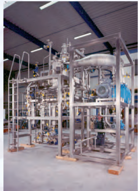
Промышленный модуль с вакуум-выпарным аппаратом
