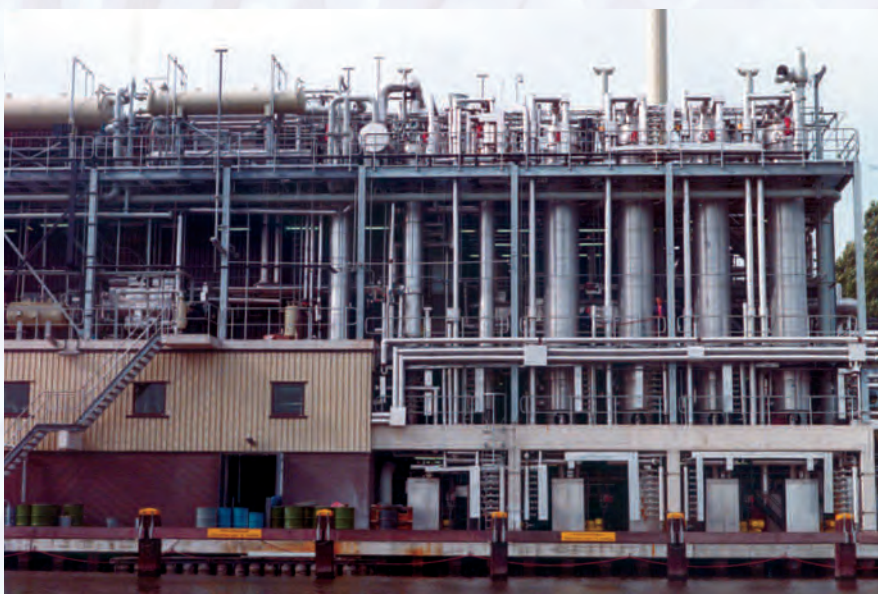
Многоступенчатая выпарная установка пленочного типа для дистилляции мисцеллы
