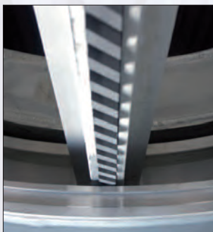
Ротор с центробежными чистящими элементами из тефлона или графита
