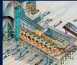
Линии для фасовки и погрузки цемента.
