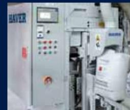
Стационарные 1–4 штуцерные машины для клапанных мешков с ручным / автоматическим режимом работы с УЗ запайкой клапана или без нее.
