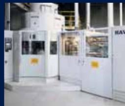
Карусельные фасовочные машины ROTOSEAL®-Packer в напольном исполнении с системой ультразвуковой запайки клапана мешка и автоматом для насадки мешков.
