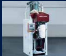
Пневматическая машина с ручным управлением для фасовки в клапанные мешки, от 1 до 3 штуцеров.
