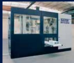
Полностью автоматизированные фасовочные машины INTEGRA® и Miniseal с системой ультразвуковой запайки клапана мешка, от 1 до 3 штуцеров.
