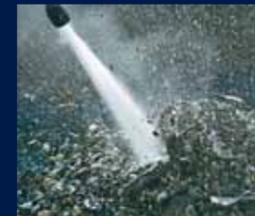
Промывочные системы высокого давления HAVER-Hydro-Clean® – для промывки сырьевых смесей, производительностью до 400 тонн в час.
