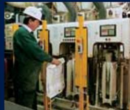
Стационарные машины для фасовки в клапанные мешки, от 1 до 4 штуцеров, для ручного или автоматического режима работы.
