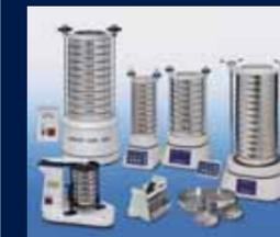
Лабораторные приборы для анализа размеров и форм частиц.
