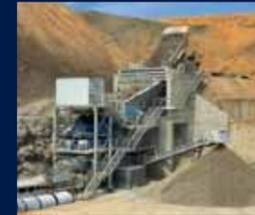
Дробильные установки для твердых пород, с надёжным эксцентриковым ситом NIAGARA®.
